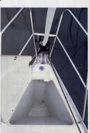
Il salpancore non è previsto, ma è possibile installarne uno verticale. Il tappo è del serbatoio dell'acqua.
