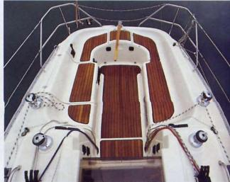
Il pozzetto è studiato per alloggiare una eventuale ruota, ma nella versione a barra l'incavo limita l'abitabilità delle panche. Il rivestimento in teak è di serie.
