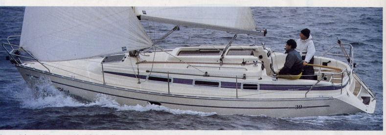
l punto di forza del Bavaria 30 Plus è l'alto coefficiente prismatico, ovverosia volumi di carena pieni alle estremità, che si traduce in un comportamento equilibrato n bolina ed una particolare vocazione alle condizioni di vento medio, le più adatte ad una barca da crociera pura. Gli importanti volumi di carena esaltano peraltro l'abitabilità degli interni, che ci sono apparsi ben sfruttati e distribuiti. Di contro, con poco vento, l'alto dislocamento penalizza un po' le prestazioni.
